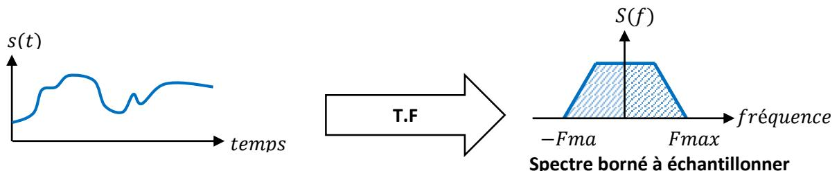
La question essentielle à se poser est : le signal échantillonné  $s_e(t)$  contient-il la même information que le signal initial  $s(t)$  ?
