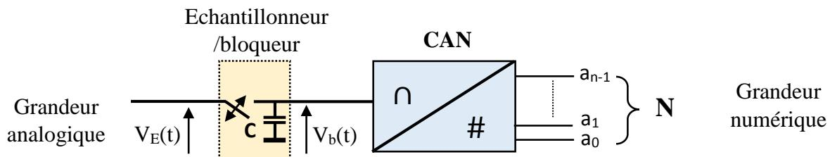
Echantillonneur /bloqueur pour maintenir la tension à l'entrée du CAN pendant toute la durée de la conversion, cette dernière s'effectue en fait sur des échantillons de la tension  $V_E(t)$  [2].
