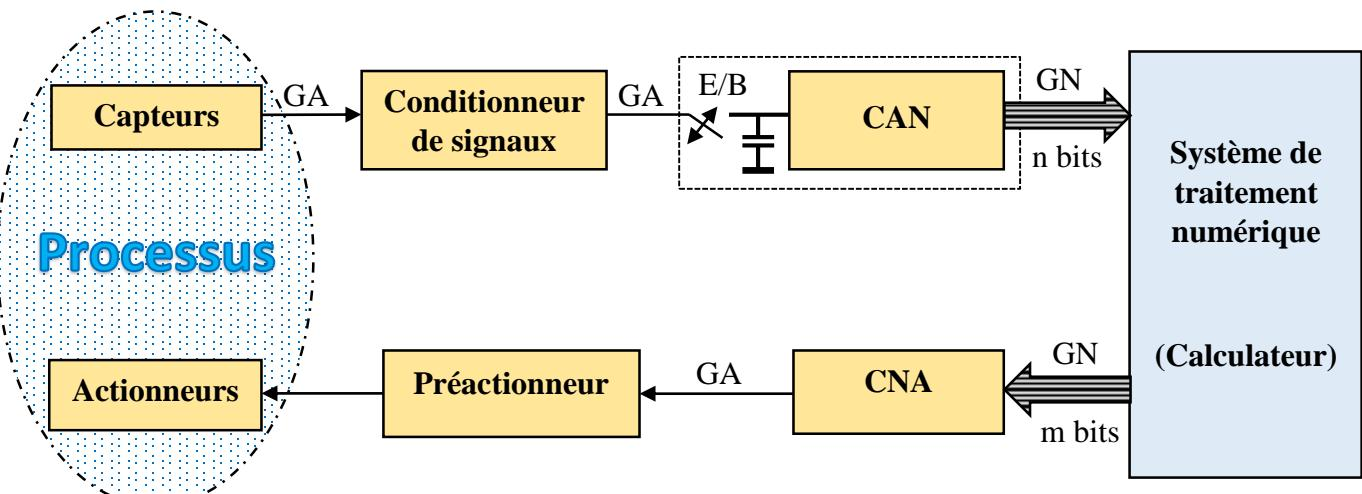
Le signal issu du capteur est mis en forme et amplifié par le conditionneur, un **CAN** (convertisseur analogique numérique) effectue **la numérisation du signal** fourni par le conditionneur, après un **échantillonnage (E/B)** éventuel [2].
