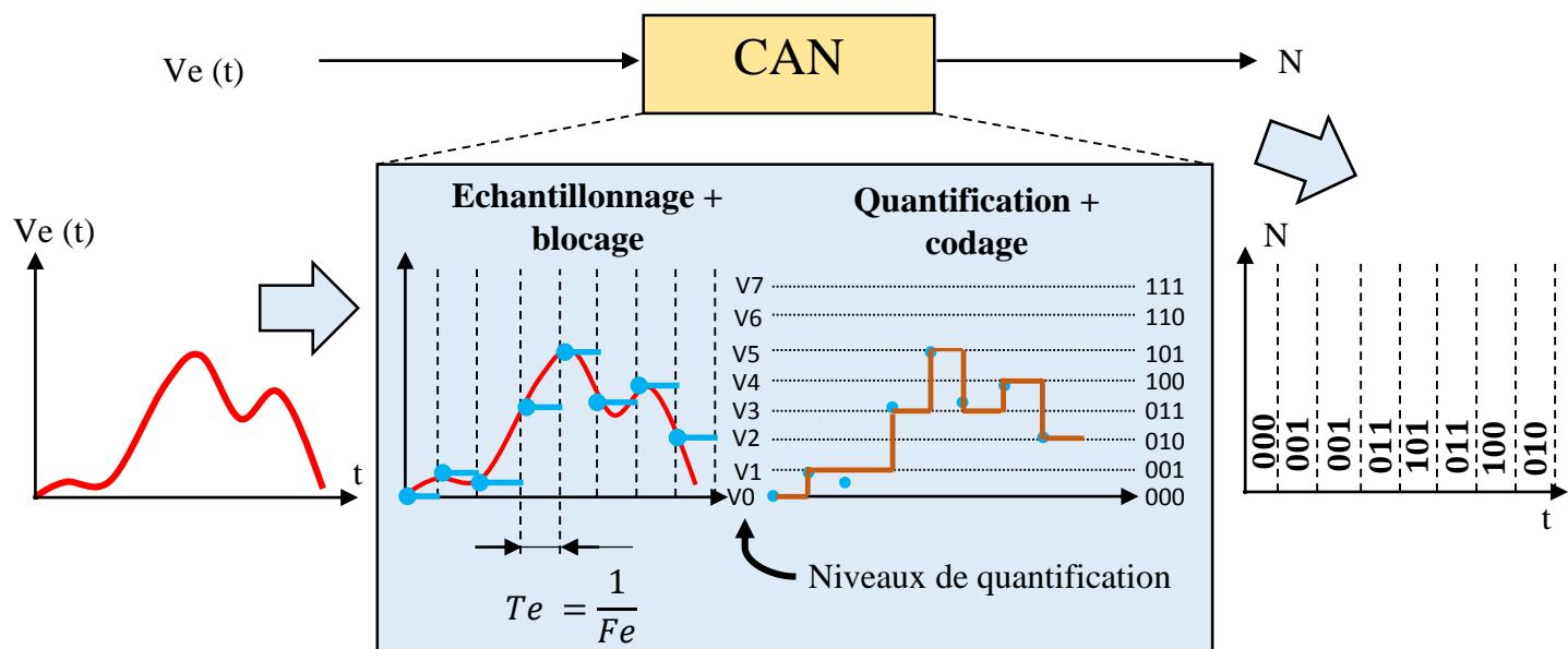
**Fe** : la fréquence d'échantillonnage (cette partie sera traitée en détail par la suite)
