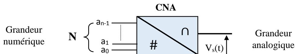
La valeur N représente la loi de commande calculée par une unité de traitement numérique, cette valeur est convertie à une tension pour commander un préactionneur. Le schéma ci-dessous représente les constituions interne d'un CNA.
