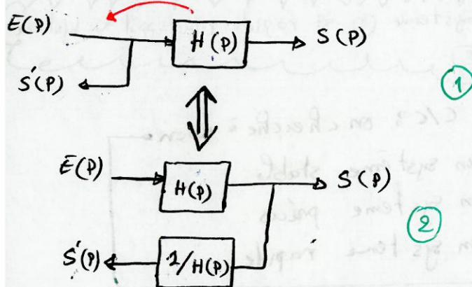
$$S'(P) = \underbrace{E(P)}_{\text{Schéma (1)}} = H(P) \cdot \frac{1}{H(P)} \cdot \underbrace{E(P)}_{\text{Schéma (2)}}$$
