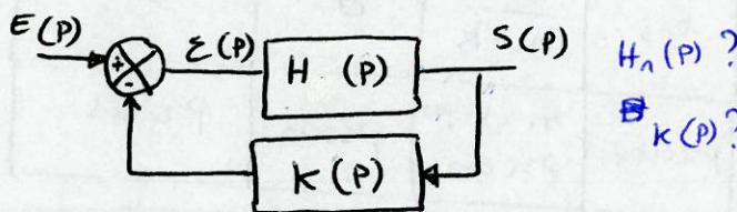
3° Calculer la fonction en boucle ouverte  $FTBO(P)$  et la mettre sous la forme suivante :  $FTBO(P) = \frac{k_{bo}}{1 + \zeta_{bo} P}$
