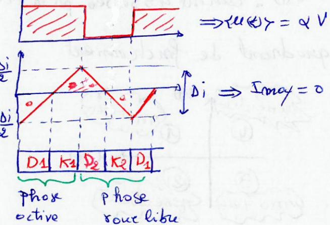
Ce fonctionnement se réalise lorsque KCC est désocoupée (pas de charge)
