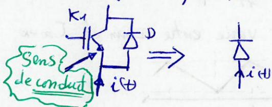
Cela dire même si on donne l'ordre de commande au transistor reste toujours bloqué car  $i(t)$  est contre le sens du transistor
