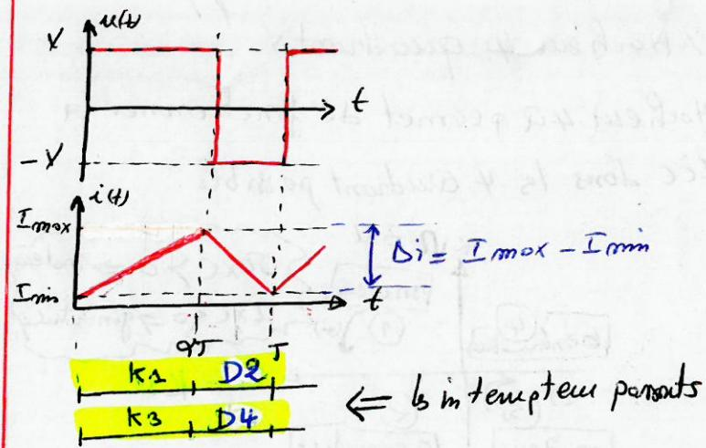
$$\text{pour } t \in [0, \alpha T] \text{ et } i(\alpha T) = I_{max}$$
