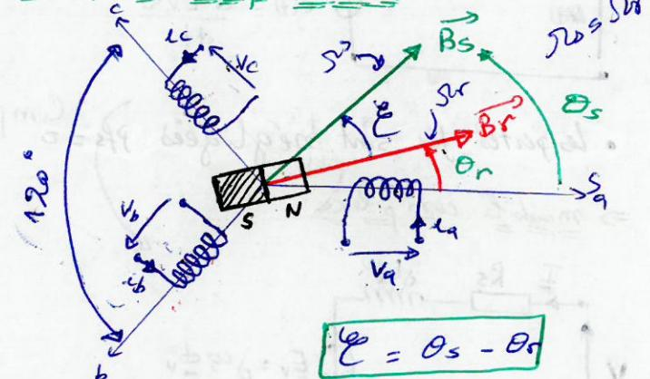
• théorème de Faraday: 3 bobines placées entre eux à un angle de  $120^\circ$ , si ils sont traversées par des courants triphasés équilibrés créent un champ tournant  $B_s$  avec une vitesse dite synchronisme:  $\Omega_s = \frac{\omega_s}{P}$ ,  $N_s = 60 \cdot \frac{f}{P}$
