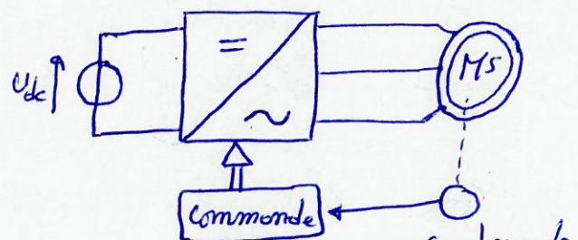
Ce capteur est pour l'objectif de contrôler la position du champ rotatif  $B_r$  par rapport au champs statique  $B_s$  à fin d'envoyer la commande à dégivrage.
