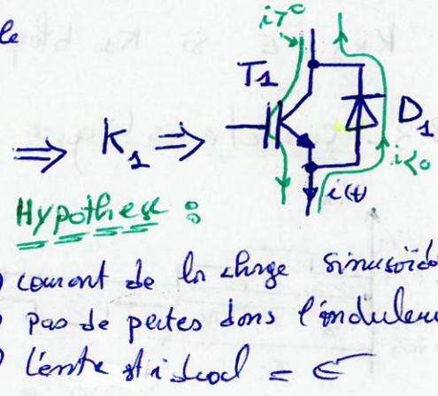
⇒ commande des interrupteurs :  $K_1 = \bar{K}_2$ ,  $K_3 = \bar{K}_4$ ,  $K_5 = \bar{K}_6$
