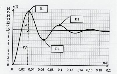
L'abaque ci-dessous permet de connaître la valeur du *Dk* dépassement relatif en fonction du facteur d'amortissement. Lorsque l'amortissement tend vers 1, on peut ainsi mettre en évidence que la valeur des dépassements est de plus en plus faible.
