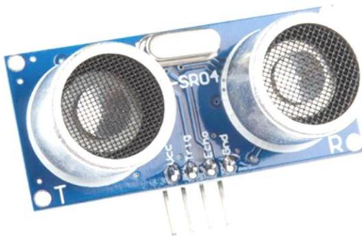
Figure 4.1 : capteur HC-SR04
