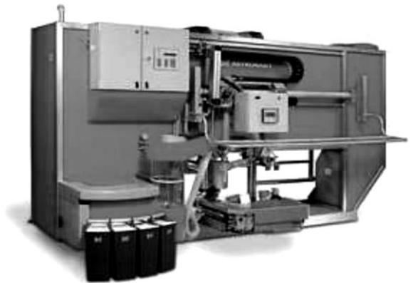
Un chariot asservi en position permet de déplacer le bras articulé. Il est monté sur des galets qui réalisent la liaison glissière de direction horizontale. L'ensemble est mu par un motoréducteur à courant continu associé à un système de transmission pignon - crémaillère.
