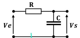
A  $t=0$ , on applique un échelon de tension  $v_e(t) = V_o \cdot u(t)$ , leur transformée de Laplace :  $V_e(p) = \frac{V_o}{p}$
